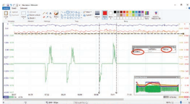
6 Detail záznamu v okamžiku, kdy motor ještě akceleruje: • plynový pedál sešlápnutý na 100 %, • tlak paliva v railu přibližně 1 800 bar (odpovídá napětí na snímači 3,5 V), • napětí signálu plnicího tlaku je 3 V (odpovídá hodnotě plnicího tlaku 2 000 mbar), • délka hlavního vstřiku cca 750 mikrosekund.
