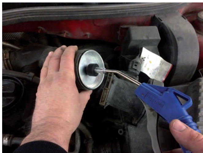
➓ Zkouška těsnosti plnicího a sacího potrubí. ↑
