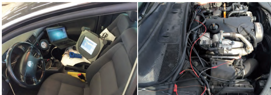
➔➓ Měřicí stanoviště na sedačce spolujezdce a zapojení měřicích přístrojů v motorovém prostoru.
