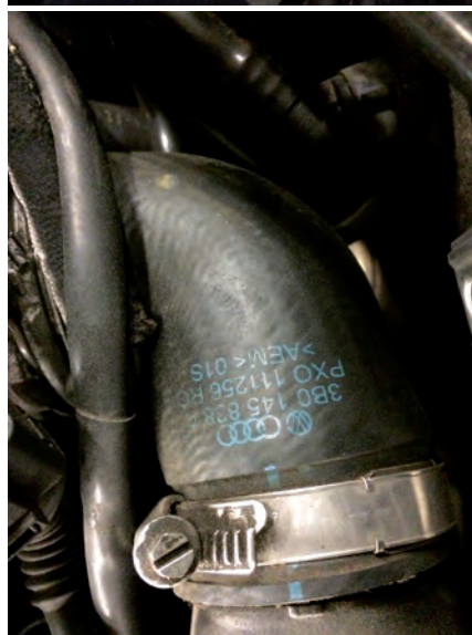
➓ Zkouška těsnosti plnicího a sacího potrubí. ↑
